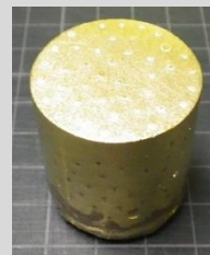
中空鉄球の鑄ぐるみ (Al, Mg, Cu)
