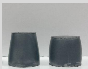
熱間で塑性加工された超硬合金
