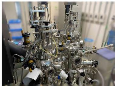
超高真空のチャンバーが2つあり、片方がPLDの成膜装置（篁研究室）もう片方がスパッタリングによる成膜装置となっています。
