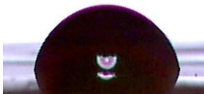
未処理の PET フィルム上に落とした水滴
