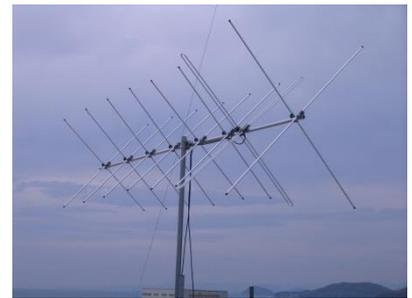
図1. 実験用クロス八木アンテナ
