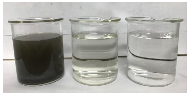
原排水と処理水の比較(処理開始後50日目) 左から、原排水、嫌気DHS処理水、脱窒DHS処理水
