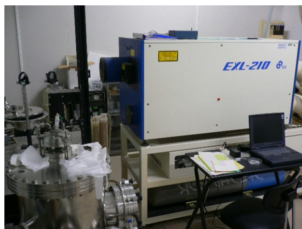
図1 PLD実験装置
