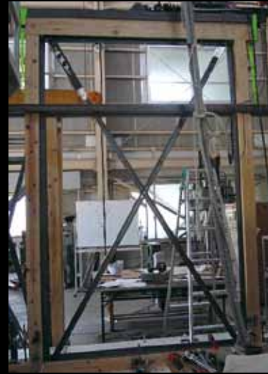
写真2 開発中の一間試験体
