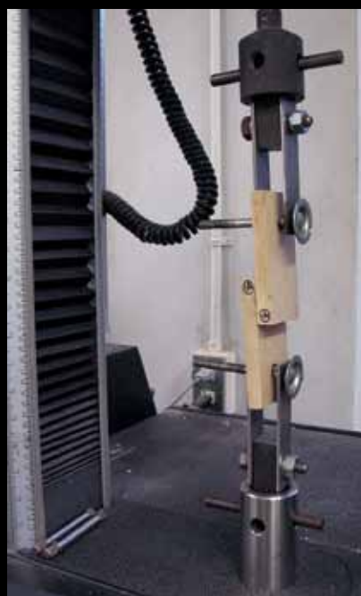
写真2 評価方法例：せん断試験
