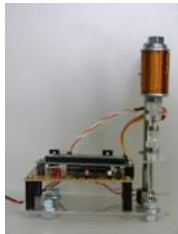
磁気浮上制御装置
