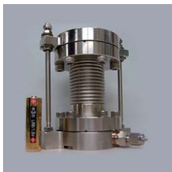
水素雰囲気中その場スモールパンチ試験装置
