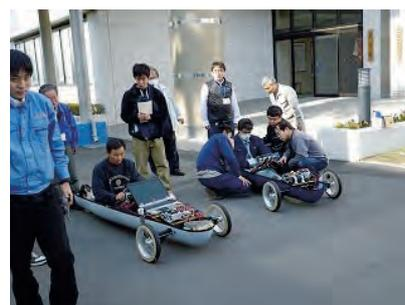
写真4 燃料電池自動車の走行試験
