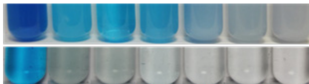
図4 上段：酸化チタンによる色素の分解過程 下段：開発した触媒による分解過程
