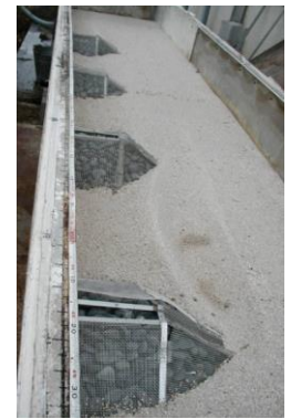
明石川水制群の実験模型
