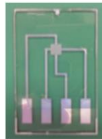
細胞単離・測定用 エレクトロローテーション マイクロウェルアレイ
