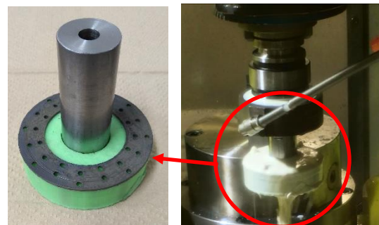
研削液内部供給機構を有する砥石
