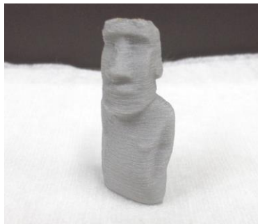
3D プリンティングで作製した砥石の例
