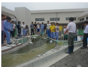
図-2 水理模型実験の様子
