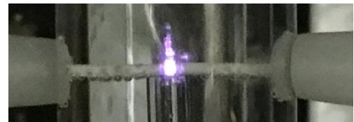
図2 放電中の電極付近の写真
