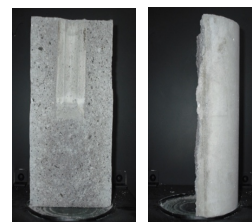
縦方向への亀裂制御
