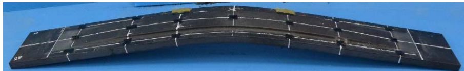
CFRP が接着接合された鋼板の曲げ試験後(CFRP 無しの際の 1.5 倍の曲げ剛性を確認)
