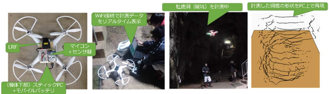
図2 ドローンに搭載した計測システムによる洞窟の内部形状計測
