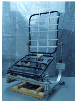
図2 起立支援機構の試作機
