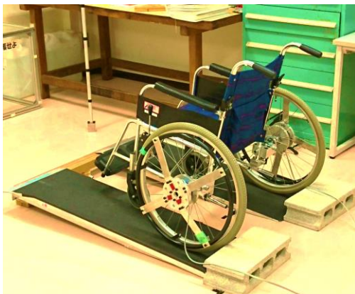
図1 操作力計測用の車いす
