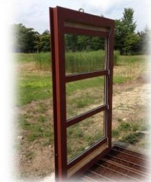
電波吸収体の曝露試験
