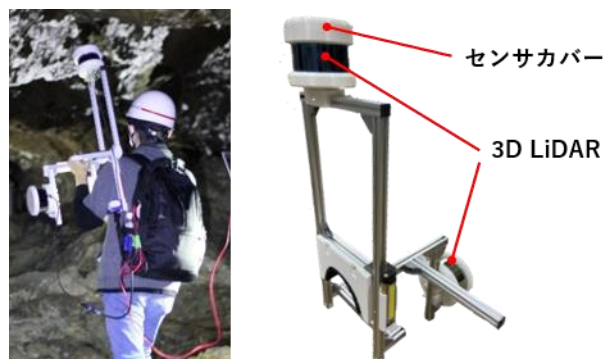
図-1 作成した3D計測用治具
