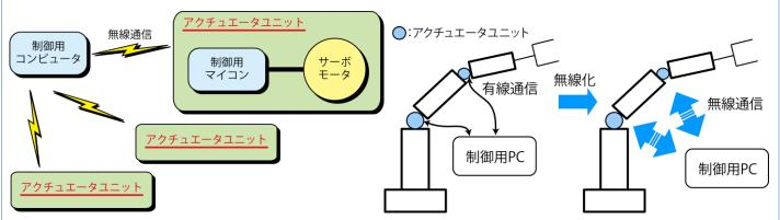
この制御システムの利点は、マイコンのみでは不可能であった高度な制御則を実現できることにあります。制御用 PC と制御用マイコンが双方向に通信を行い、コンピュータにより計算された高度な制御則を、無線通信を介してマイコンが実現しています。したがって、サイズの制約を受けることなく、下図のような小型でも高性能なロボットを構成することが出来るようになります。現在は、無線によるフィードバック信号の時間遅れによる誤差を軽減するための手法を研究・開発しています。
