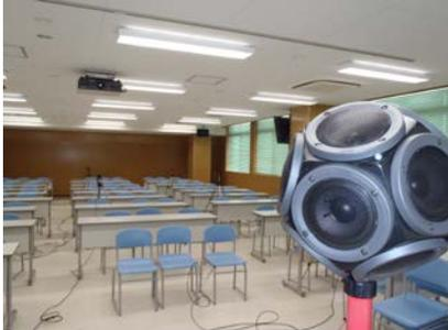
無指向性音源による音響計測風景
