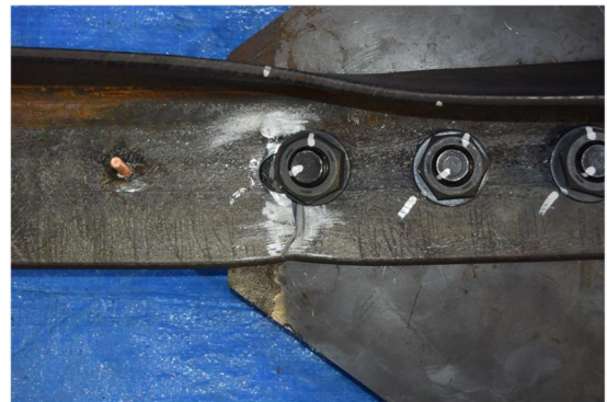
実験結果の一例(山形鋼接合部実験の様子)
