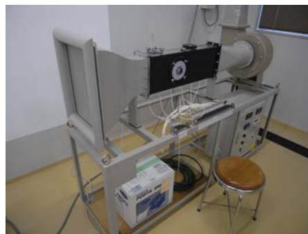
空気力学実験装置(左:同遠心送風機 中央:小型風洞 右:コンプレッサー)
