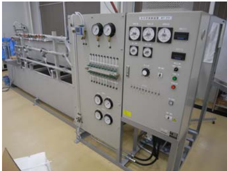
水力学実験装置(左:同計器 中央:同水槽および三角堰流量計 右:フランシス水車とペルトン水車発電機)
