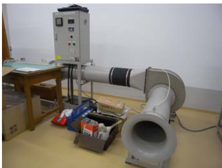
空気力学実験装置(左:同遠心送風機 中央:小型風洞 右:コンプレッサー)
