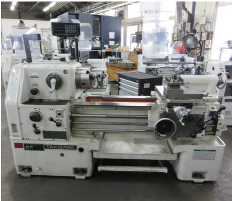
図1 汎用高速旋盤
