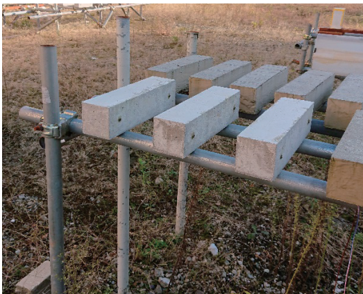
コンクリートの屋外暴露実験
