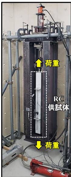
図-1 持続的な引張力を载荷する試験装置
