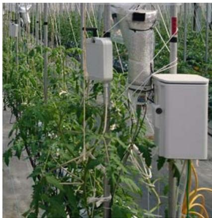
工場やラインを自動化する **Society5.0** を実現するために、IoT システムによる計測・制御が求められています。しかし、高温・多湿・粉塵など、過酷な環境向けのシステム構築にはノウハウが必要です。左の写真は、ビニールハウス内で**植物の光合成量を最大化**するように開発した、冷暖房や CO<sub>2</sub> 施用を制御するための計測システムです。
