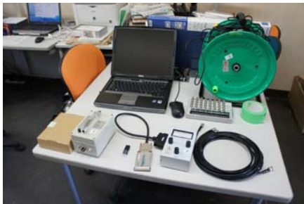
常時微動計測システム
