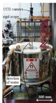
図1 リソチウム結晶の熱物性値計測
