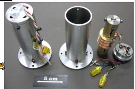
図2 工作機械の軸ズレ検知センサ
