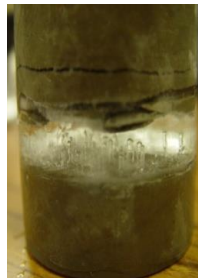
← 三軸試験の様子と凍上試験後の岩石試料
