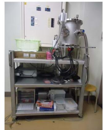
写真1 真空蒸着装置
