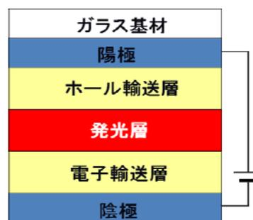
図2 有機薄膜の模式図
