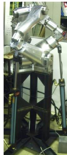
先端許容負荷1ton のメガロボット用試作4号機
