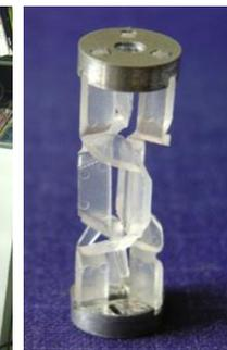
射出成型で製作した医用鉗子先端関節用の試作5号機(直径10mm)
