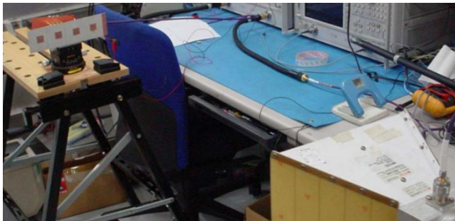
フェーズドアレーアンテナの測定
