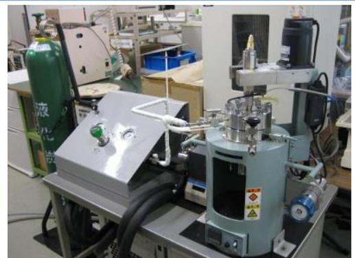
図2 超臨界二酸化炭素処理装置
