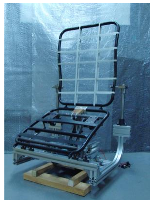
図 2 起立支援機構の試作機
