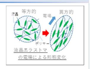
しかし,長さの2乗の部分は液晶分子の位置のみに依存するため,弾性エネルギーが方向依存になるとすれば弾性係 数の部分になるはずである。この考えを推し進めると、弾性係数は液晶の位置と向きに依存していなければならないと いうことになる。ではどうすればそのような状況が自然に説明できるか?その一つの答えは、材料内部の長さの単位を 決める計量が液晶分子の向きに応じて変化すると考えることである。このように考えると、図のような変形がうまく説明 できる。実際, Finsler 幾何モデルによる LCE の弾性エネルギーは, 分子間の距離の 2 乗だけでなく弾性係数も, LCE の変形に依存して変化する。さらに弾性係数が小さい(大きい)ところでは分子間の距離が大きく(小さく)なる。これによ り,弾性係数は液晶分子の向きの揺らぎで決まる様々な分子間距離で平均されるというメカニズムが働く。このことか ら,弾性エネルギーのその場所での平均値,さらに,LCE 全体の弾性エネルギーが決まり,マクロな変形が決まる。
