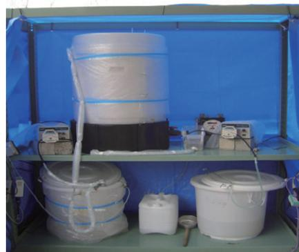
写真：さぬきうどん廃水処理装置全景
