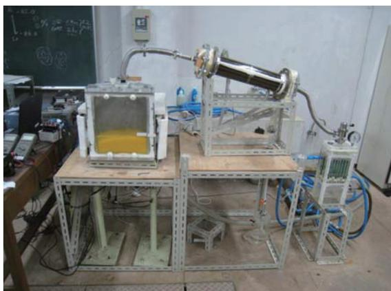
写真2 超音波印加型蒸留装置
