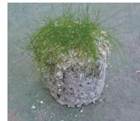
写真-2 植栽試験終了後供試体
