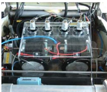
図1 150W燃料電池発電システム
