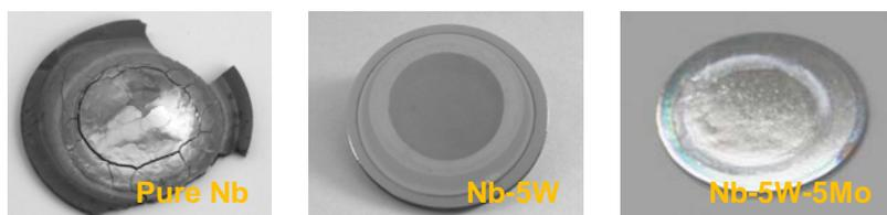
図2 水素透過試験後の概観写真
