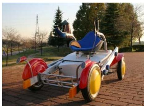
図2 前輪インホイールモーターとジョイスティックを採用しユニバーサルデザインを実現
