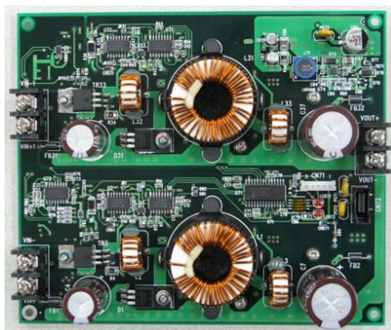
図1 デジタル制御+アナログ制御MPPT
