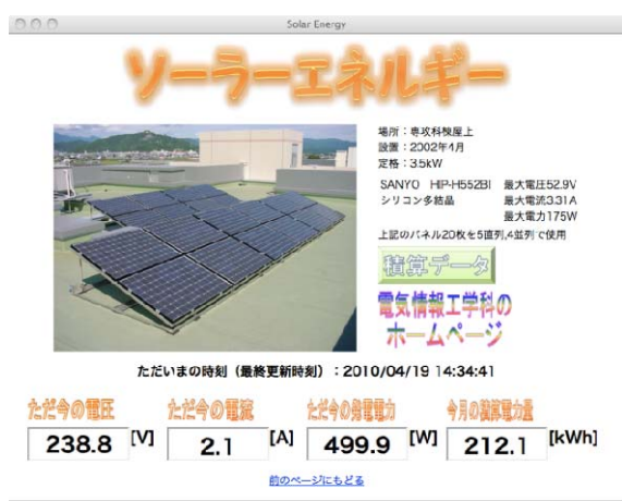
図1 太陽電池モニタリングシステム
