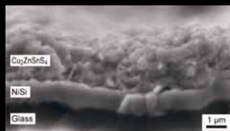
図3 NiSi電極層の上に形成したCZTS光吸収層
