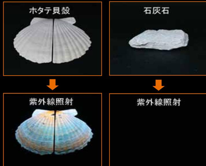
図1 同じ処理をした貝殻と石灰石の蛍光現象
