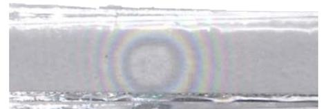
図2 超短光パルスマイクロ接合法を用いたガラス間の接合
