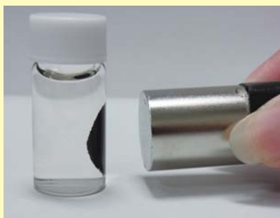
●図1 水中で磁力に反応する吸着剤
