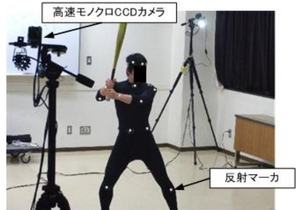
図1 モーションキャプチャーを用いた3次元運動計測風景
