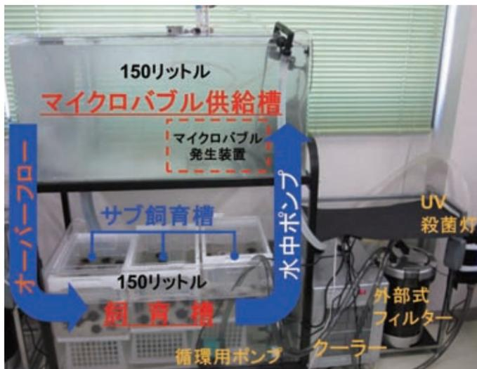
写真1 完全閉鎖型陸上養殖システム(300L)
