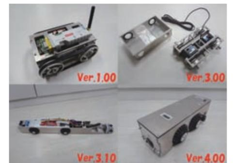
写真3 配管検査ロボット "Orange-Sweetie"
