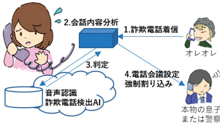
振り込め詐欺などの電話を使った詐欺通話を音声認識と詐欺通話判定を行う AI を使って検出し、被害を防止する。電話機では会話内容をデジタル化してインターネットを介した音声認識機能を使ってリアルタイムでテキスト化し、さらに詐欺電話である可能性を、人工知能を用いて判定する。詐欺電話の可能性が高ければ(回線を切断するだけでは発信者側に詐欺電話と判断したことが伝わらないため)事前に登録されている親族もしくは捜査機関に発信して電話会議を開設して第三者を割り込ませる。技術的には既存電話回線, スマートフォンなどのソフトフォンなどに応用可能である。また電話機に実装することで、通信の秘密の保護義務に抵触しない。
