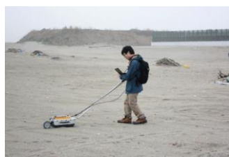
地中レーダの使用例(左:東日本震災不明者搜索, 右:堤防点検)
