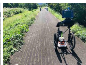
地中レーダの使用例(左:東日本震災不明者搜索, 右:堤防点検)
